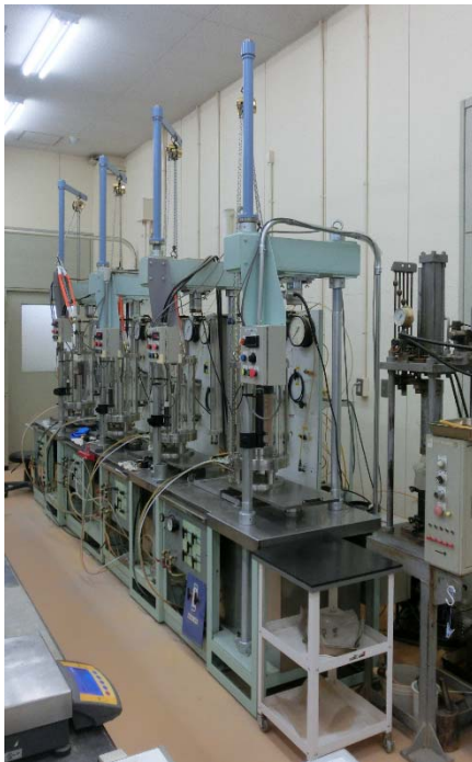
中型三軸試験機のセル交換＋クレーン増設
