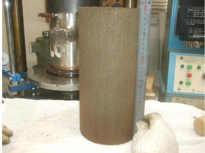
写真3 脱型（抜き取り）後供試体
