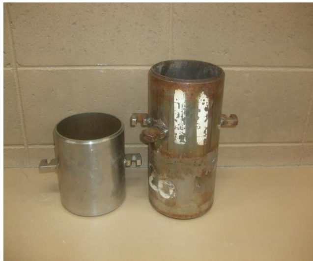
写真 1 作製したモールド (右) (左は従来の 15cm モールド)
