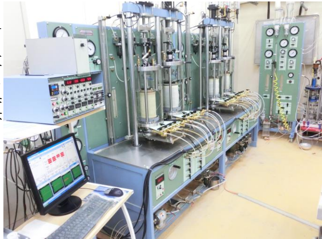
設置完了した新設の(静的、動的)三軸試験機
