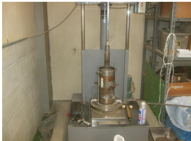
写真 2 供試体作製状況
