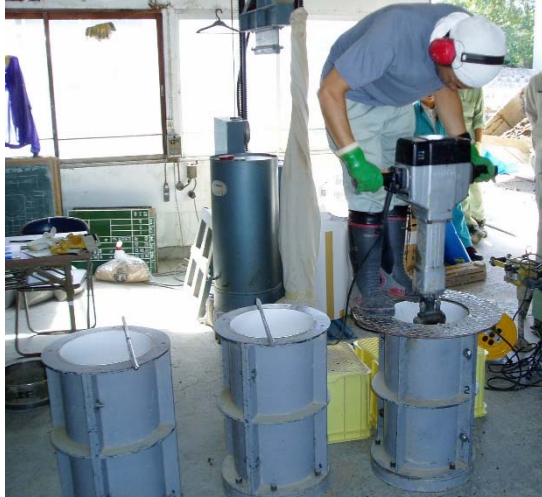
大型供試体の作成状況
