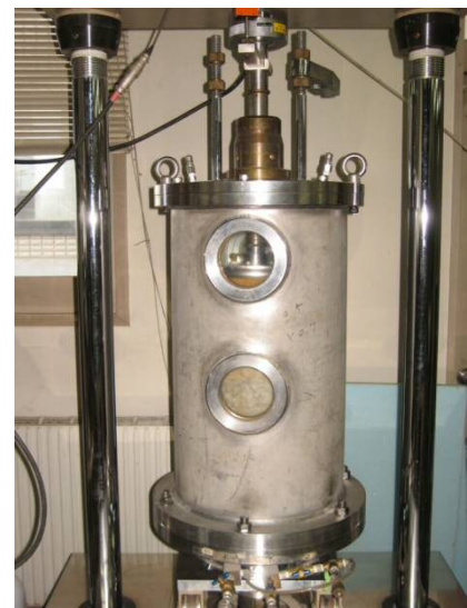
三軸圧縮試験装置 (φ200mm用)
